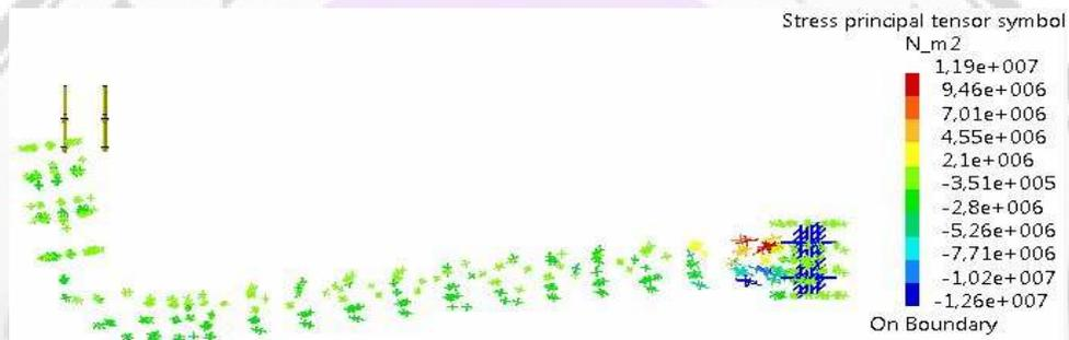
Gambar 3. Tegangan maksimum Tensor sebesar  $1,19 \times 10^7 \text{ N/m}^2$
