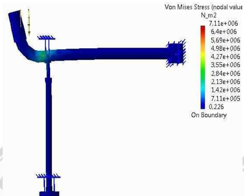
Gambar 7. Tegangan maksimum Von Mises rangka putar dengan menggunakan rangka penopang sebesar  $7,11 \times 10^6 \text{ N/m}^2$
