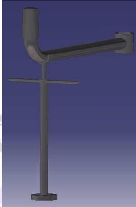
Gambar 4. Rangka putar dengan menggunakan rangka penopang
