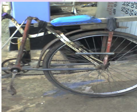
Gambar 4.1 Tempat Duduk Pengayuh Becak Sebelum Perbaikan
