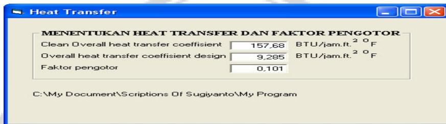
Gambar 8. Hasil Eksekusi Perhitungan *Overall Heat Tranfer Coefficient* Dan Faktor Pengotor
