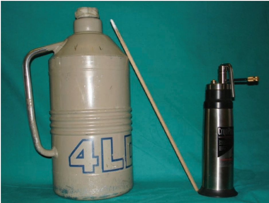
Slika 3. Rezervoar tekućeg dušika s aplikatorom i kriosprej
