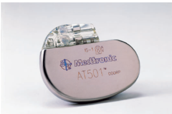
Slika 1. Prosječan DDD-elektrostimulator (5,0 x 4,5 x 0,7 cm)
