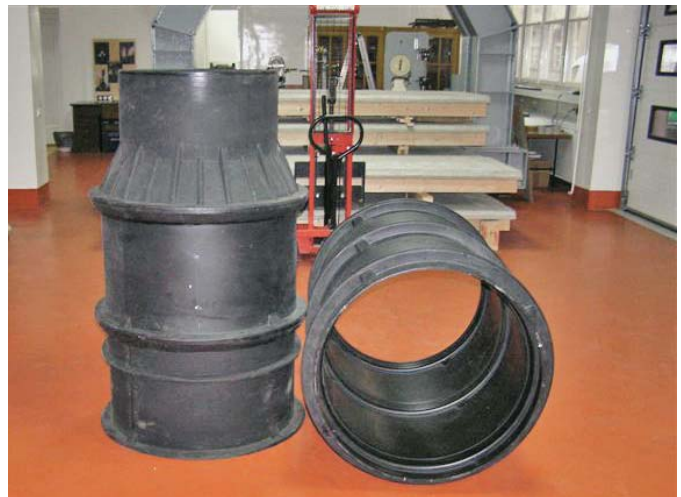
SLIKA 1. Polietilenska okna unutarnjeg promjera DN 800 mm FIGURE 1. Polyethylene pits with inner diameter of DN 800 mm
