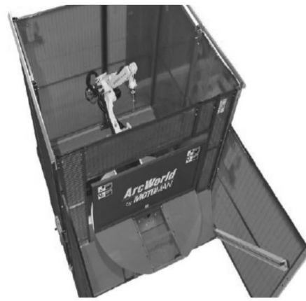
Slika 1. Zaštita radnog područja robota mehaničkom barijerom
