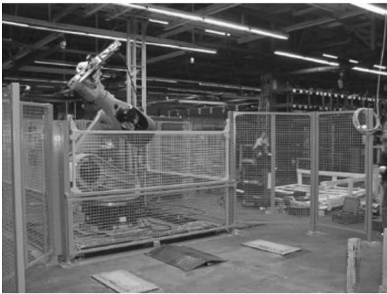
Slika 1. Zaštita radnog područja robota mehaničkom barijerom
