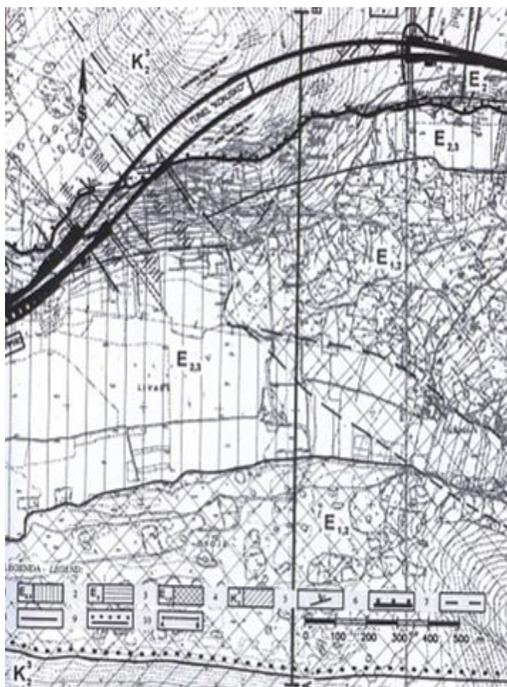
Sl. 3. Geološka karta šireg područja Konjskog (bez površinskog pokrivača). Legenda: 1- lapori eocenskog fliša, 2- glaukonitni laporoviti vapnenci, 3- foraminiferski vapnenci, 4- rudistni vapnenci, 5- položaj sloja, 6- navlaka, 7- pretpostavljeni rasjed, 8- normalna litološka granica, 9- diskordantna granica, 10- profil
