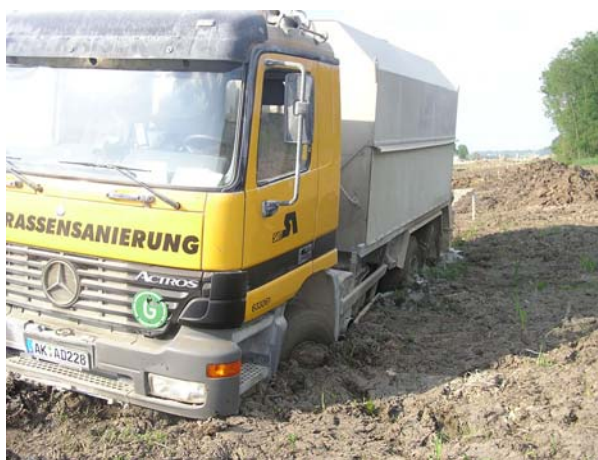
Slika 5. Nosivost tla na probnom polju
