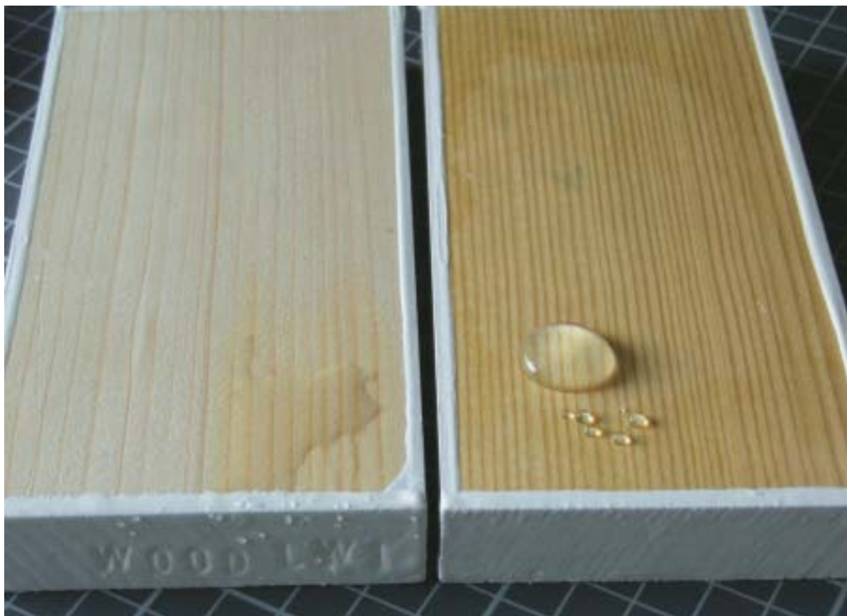
Slika 5. Povećanje hidrofobnosti drva obrađenog hidrofobnim impregnacijskim sredstvom (desno) u usporedbi s neobrađenim drvo (lijevo); foto: Turkulin
