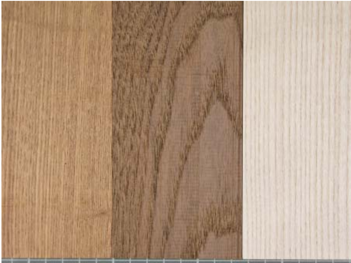
Slika 2. Prirodna jasenovina (desno) i toplinski obrađena jasenovina pri različitim temperaturama (lijevo i u sredini); foto: Turkulin
