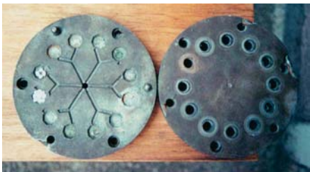
SLIKA 3. Izvorne kalupne ploče kalupa za izradbu zatvarača za paste (1934.), foto I. Juraga
