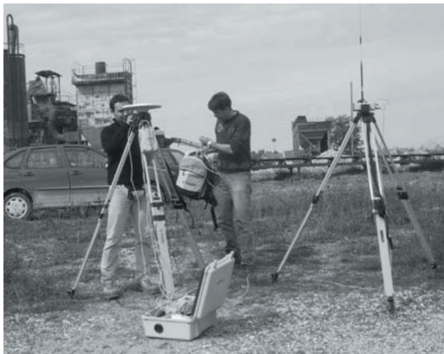
Trimble 5700 RTK komplet: referentni prijamnik s radio odašiljačem
