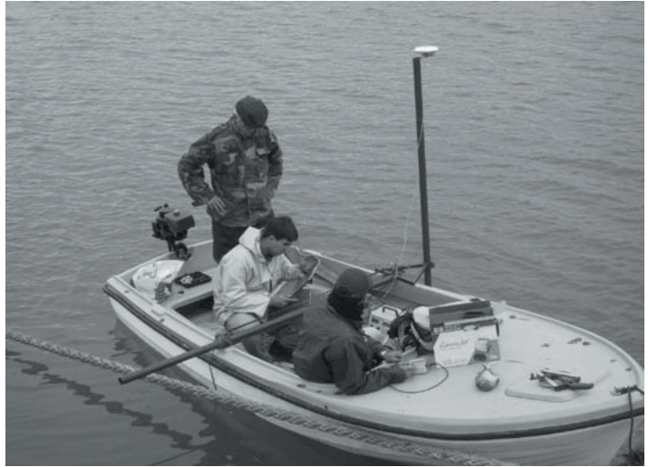
Kombinacija RTK-GPS/ehosonder na jezeru Novo Čiče: bazni prijamnik s radio-odašiljačem (lijevo), pokretni prijamnik s ehosonderom na brodu (desno)
