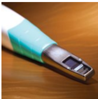
شکل ۱۱. wand IOS FastScan™ در [۱۷]
