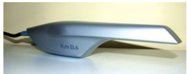
شکل ۱۳. wand در Hint-ELs® directScan [۱۲]
