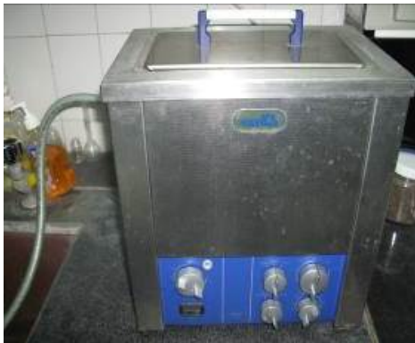
تصویر شماره ۲: تصویر راکتور التراسونیک (Batch)
