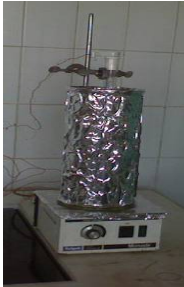
تصویر شماره ۱: نمای کلی و داخلی راکتور فتوشیمیایی (فرابنفش)
