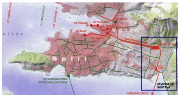
Slika 1. Situacijski položaj završnog dijela kanalizacijskog sustava Split/Solin
