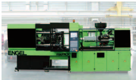
SLIKA 14. Englova ubrizgavalica macPACK 330/125
