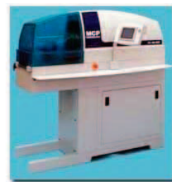
SLIKA 16. Ubrizgavalica MCP 12/90 HSE
