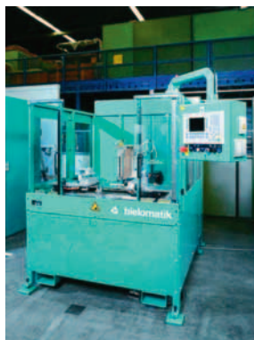
SLIKA 31. Lasersko zavarivanje polimera tvrtke Bielomatik
