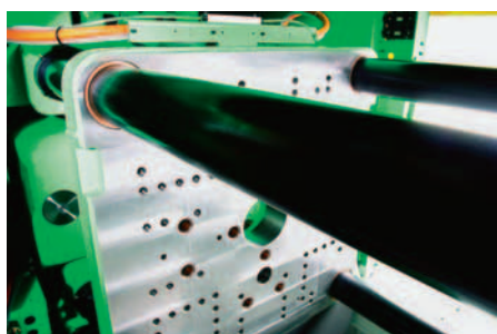
SLIKA 8. Priječnice ubrizgavalice poslije Arnoxova postupka
