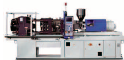
SLIKA 17. Demagova mikroubrizgavalica IntElect 50/330-45
