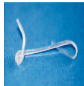
SLIKA 32. Polimerni izradak sa svojstvom prisjećanja tvrtke mnemoScience
