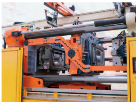
SLIKA 15. Tandem Moulding System tvrtke Husky
