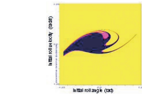
Figure 16 Safe basin in the initial value plane, intact ship with bilge keels Slika 16 Bazen sigurnosti u ravni početnih uvjeta, neoštećeni brod s lujlnim kobilicama a=0.21705, \omega=\omega_0
