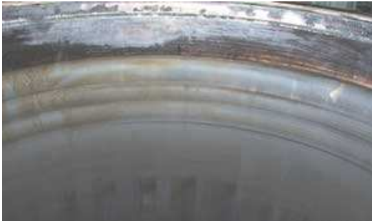
Slika 2b: Površina košuljice cilindra nakon završetka honanja
