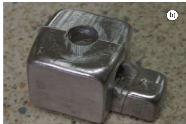
Figure 6. The local squeezing process performing. a) Dependence diagram of the temperature versus time of casting pouring and solidification, and time of the local squeezing process performance. b) Photography of the obtained test sample Izvođenje postupka lokalnog tiskanja. a) Dijagram ovisnosti temperature od vremena pri lijevanju i skrućivanju odljevka, te tijekom izvođenja postupka lokalnog tiskanja (kp 7). b) Fotografija dobivenog ispitnog uzorka
