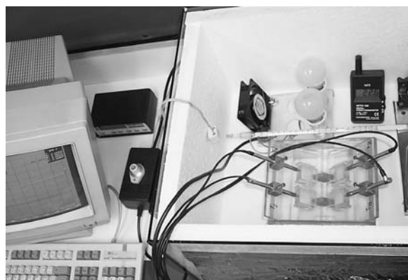
Figure 1 Device for the determination of radial and tangential swelling including monitoring unit (photograph – top view) Slika 1. Uređaj za određivanje radijalnoga i tangencijalnog bubrenja, uključujući uređaj za praćenje (fotografija – pogled odozgo)
