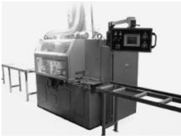
Figure 1 A testing stand for high-speed milling Slika 1. Stroj za blanjanje drva velikim brzinama pripremljen za istraživanje
