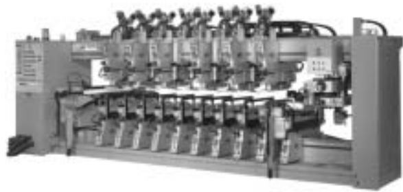
Figure 4 Passage multiple-spindle drillers (Biesse- Italy) Slika 4. Viševretene bušilice za prolazne rupe (Biesse- Italija)
