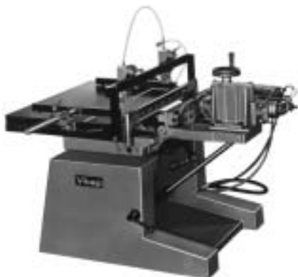
Figure 3 Cyclic multiple-spindle drillers (Vitap- Italy) Slika 3. Ciklične viševretene bušilice (Vitap- Italija)
