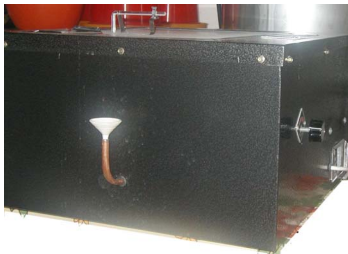
Sl. 2.: Eksperimentalna sušnica za biljni materijal – bočni pogled
