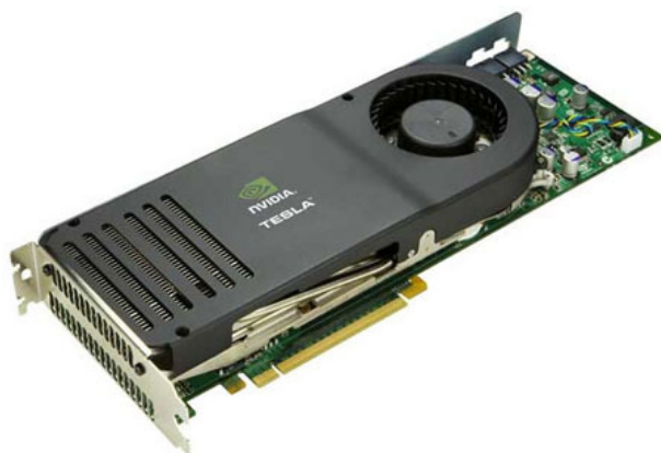
Figura 4: una delle otto schede GPU/Tesla per supercalcolo presenti nei nostri laboratori
