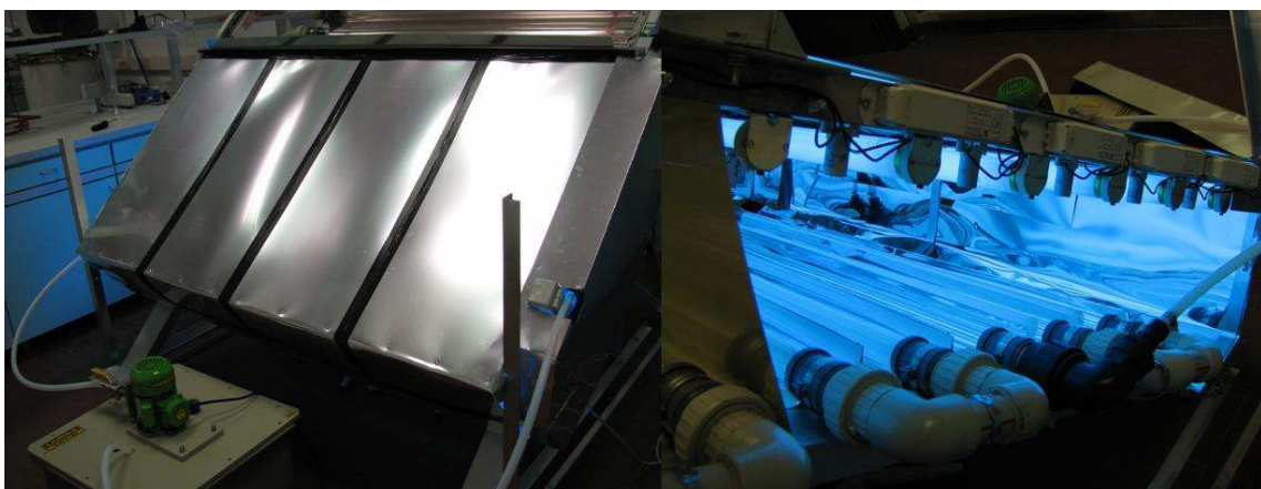
Slika 15: Pilotni sistem, ki smo ga uporabljali za izvajanje poskusov fotokatalitske razgradnje.
