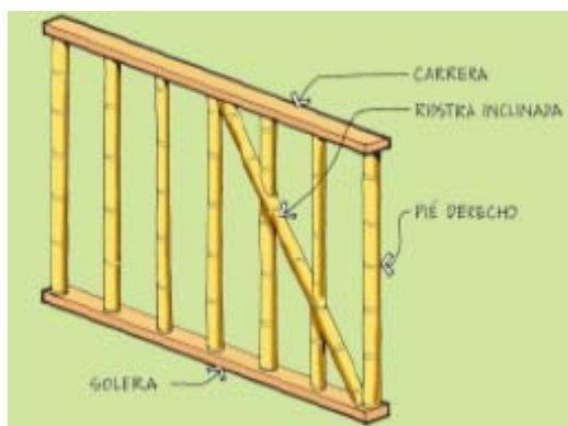
Figura 1. Entramado de guaduas que conforman un muro de Bahareque Encementado (AIS, 2000)
