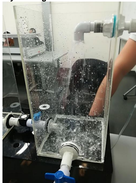
Figura 62. Prueba de llenado y anti fugas
