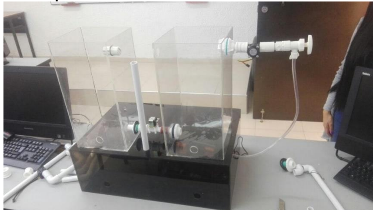
Figura 59. Inicio de acople de tubería
