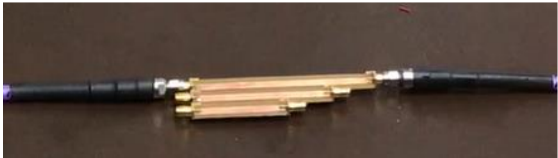
Figura 53 Calibración con línea de transmisión
