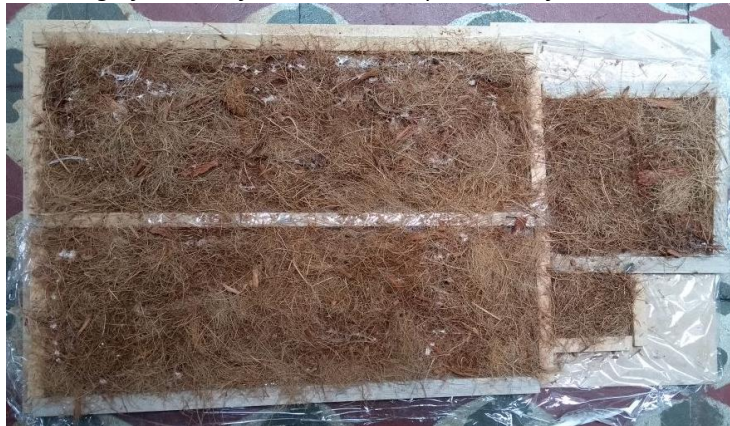
Fotografía 10 Conformación de los paneles de fibra de coco.
