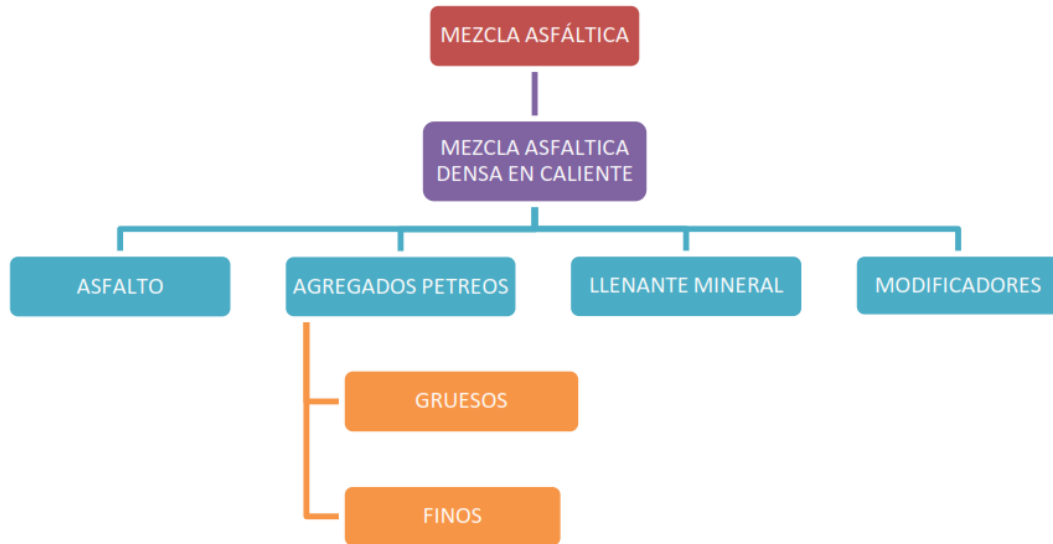
Figura 3. Componentes de una mezcla asfáltica.
