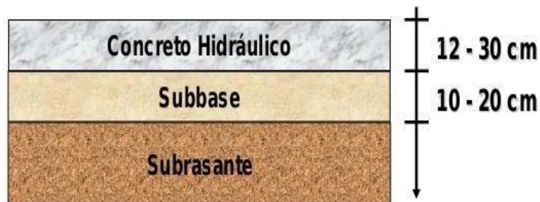
Figura 11 Capas de una estructura de pavimento rígido
