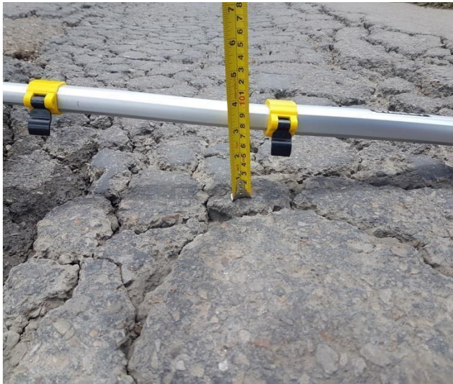
Hundimiento con piel de cocodrilo
