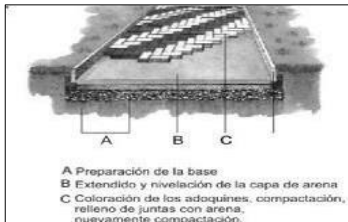
Figura 3. Elaboración de Vía con Pavimento Articulado
