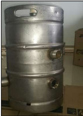
Figura 6. Tanque Banco Hidráulico
