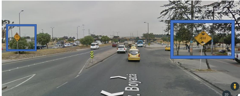
Figura 52: señalización preventiva de altura de paso a desnivel.
