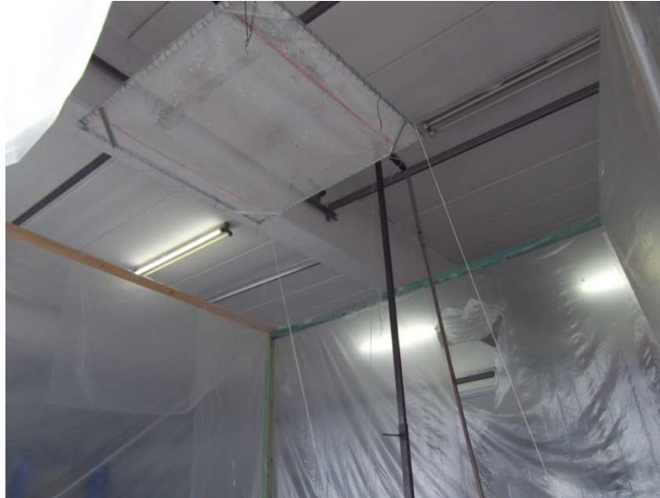
Figura 3.5. Fotografía de la cámara del simulador de lluvia
