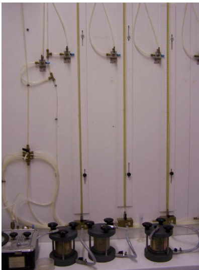
Figura 3.7. Arreglo experimental para la prueba de conductividad hidráulica.
