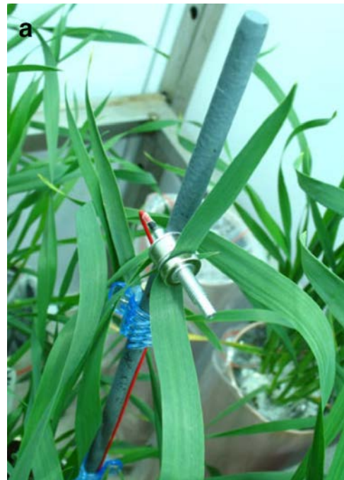
Figure 88: Leaf clamp ( http://yara.zim-plant-technology.com/de/?Produkte )
