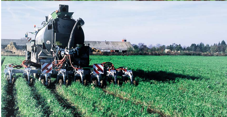
Figure 42: Strip till in a catch crop canopy in fall ( www.lksh.de/fileadmin/dokumente/Bauernblatt/PDF_Toepfer_2014/BB_24_14.06/39-41_Tauchnitz_Bischoff.pdf )
