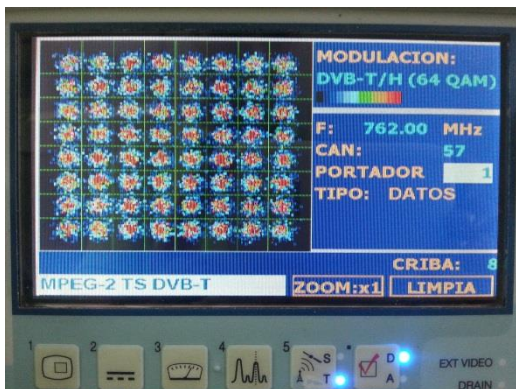
Figura 4. Diagrama de constelación para una señal con más ruido
