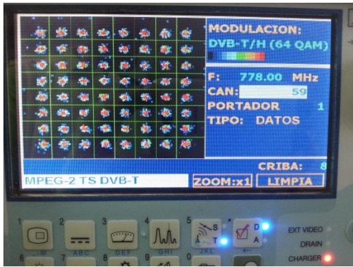
Figura 3. Diagrama de constelación para una señal con poco ruido
