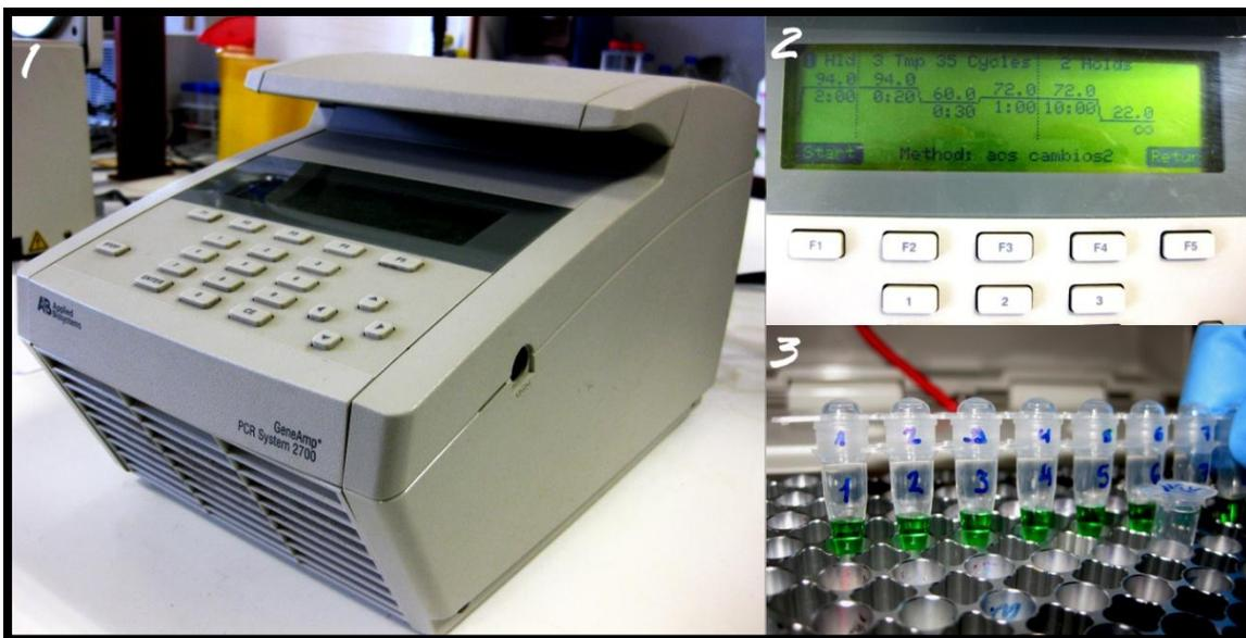
**Figura 18: 1: Gene Amp PCR System 2700 donde se realizó la PCR. 2: Programa de PCR diseñado para amplificar el fragmento de interés del gen *CpACS2/7*. 3: Tubos de PCR insertos en el bloque del termociclador.**
