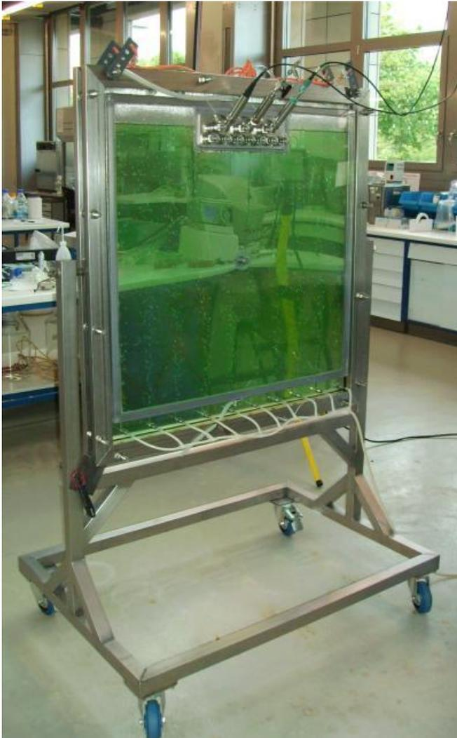
Figura 19. Reactor *flat-plate*, diseñado para una captación óptima de luz en el Departamento de Ingeniería de Bioprosos de la Universidad de Karlsruhe, Alemania.
