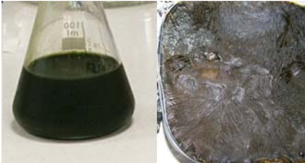
Figura 18. Hidrolizado final de Anabaena (izquierda) y residuo sólido (derecha).
