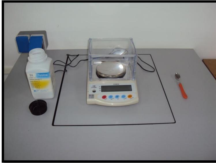
Figura nº 46. Báscula de precisión empleada para la preparación de las soluciones salinas.
