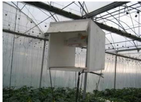
**Figura 17.** Detalle de un sensor de temperatura y humedad relativa en el interior de un invernadero (Hobo).
