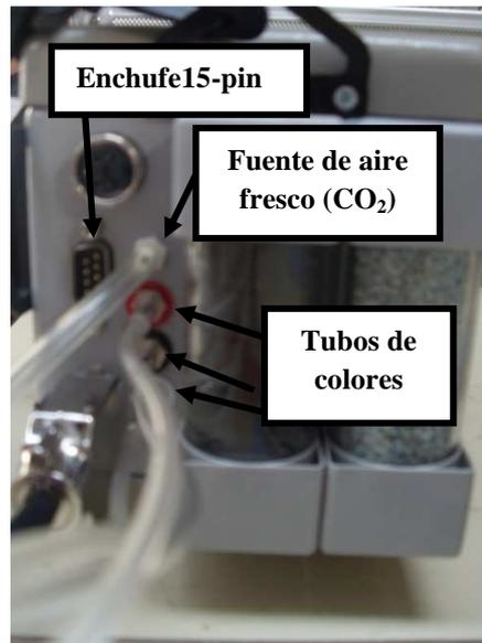
**Figura 40.** Detalle de las conexiones de los cables al medidor LCi Portable Photosynthesis System.
