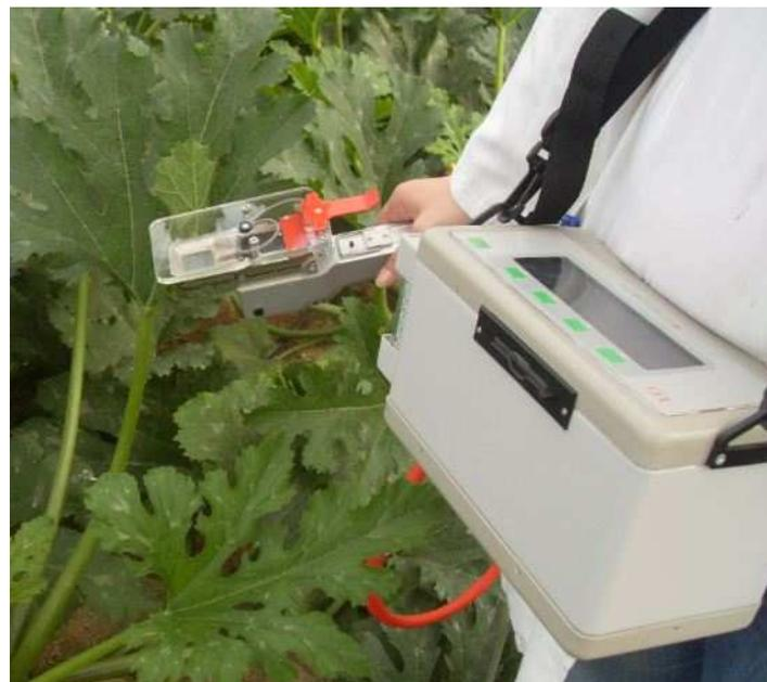
**Figura 35.** Detalle midiendo en el interior del invernadero en el ensayo 1 con el medidor LCi Portable Photosynthesis System.
