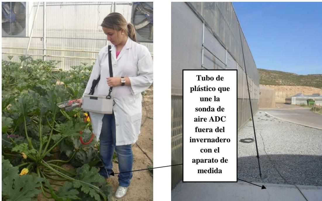
*Figura 46.* Detalle de la toma de medida del ensayo 2.
