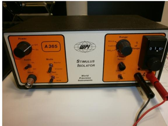
FIG. 1- Fuente de corriente generadora de estímulos eléctricos
