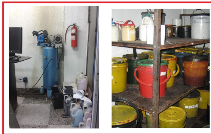
Imagen 10. Almacenamiento inapropiado de desechos líquidos
