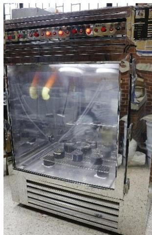
*Figura. 2 Cámara de acondicionamiento de humedad relativa y temperatura controlada*
