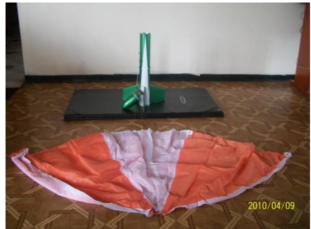
Figura 42. a. Mecanismo expulsor y líneas de recuperación. b. Cohete con el paracaídas desplegado.
