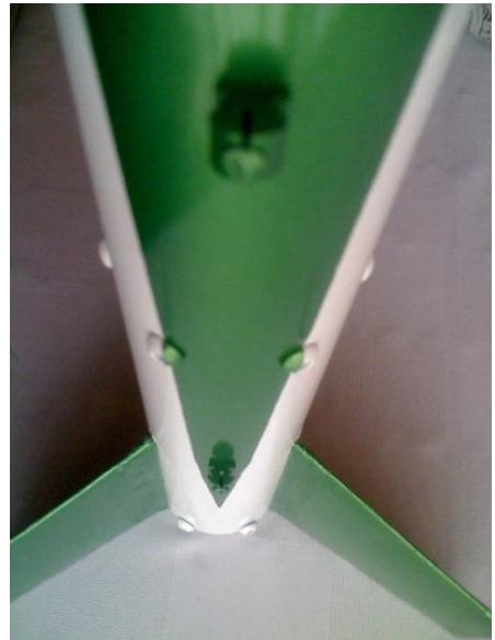
Figura 43. a. Guía de lanzamiento. b. Guías de riel en el fuselaje.
