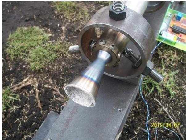
Figura 46. Estado de la tobera luego de la prueba del motor.
