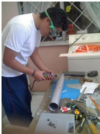
Figura 2. a. Maquinado de las ranuras para acople de aleta. b. Ranura para acople de aleta.
