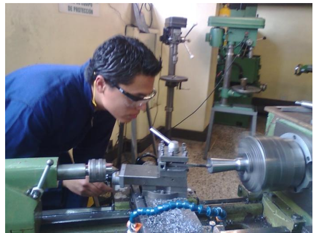
Figura 17 a. Vista lateral de la tobera. b. Mecanizado de la sección divergente.
