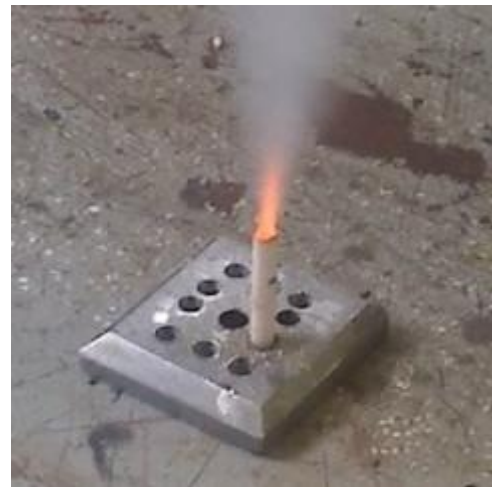
Figura 23. a. Muestras de propelente. b. Probeta de propelente encendida.
