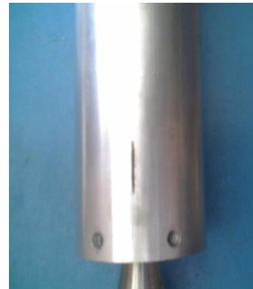
Figura 2. a. Maquinado de las ranuras para acople de aleta. b. Ranura para acople de aleta.
