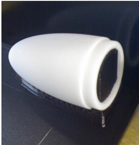
Figura 7. a. Nariz resultante del prototipado rápido b. Diseño de la nariz SolidWorks (photoview360)
