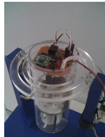
Figura 72. a. Banco de prueba. b. Sistema de gimbal y circuito de adquisición de datos.
