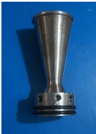
Figura 17 a. Vista lateral de la tobera. b. Mecanizado de la sección divergente.
