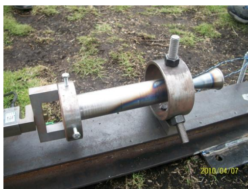
Figura 47. a. Estado del casing luego de la prueba del motor. b. Marcas por calentamiento.
