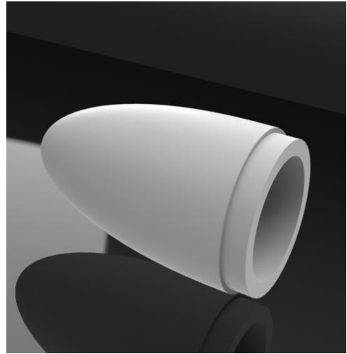
Figura 7. a. Nariz resultante del prototipado rápido b. Diseño de la nariz SolidWorks (photoview360)
