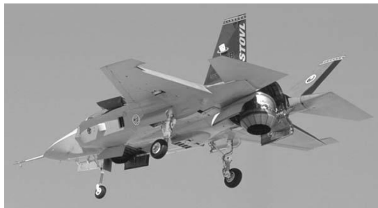
Figura 56. Avión F35 en ascenso vertical, con tobera inclinada 90 grados.
