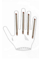
Figura 1.8: Guante con sensores de flexion.
