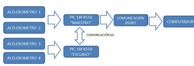
Figura 3.12: Sistema de captura de movimiento utilizando comunicación I2C
