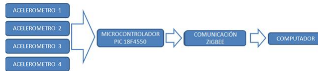
Figura 3.13: Sistema de captura de movimiento
