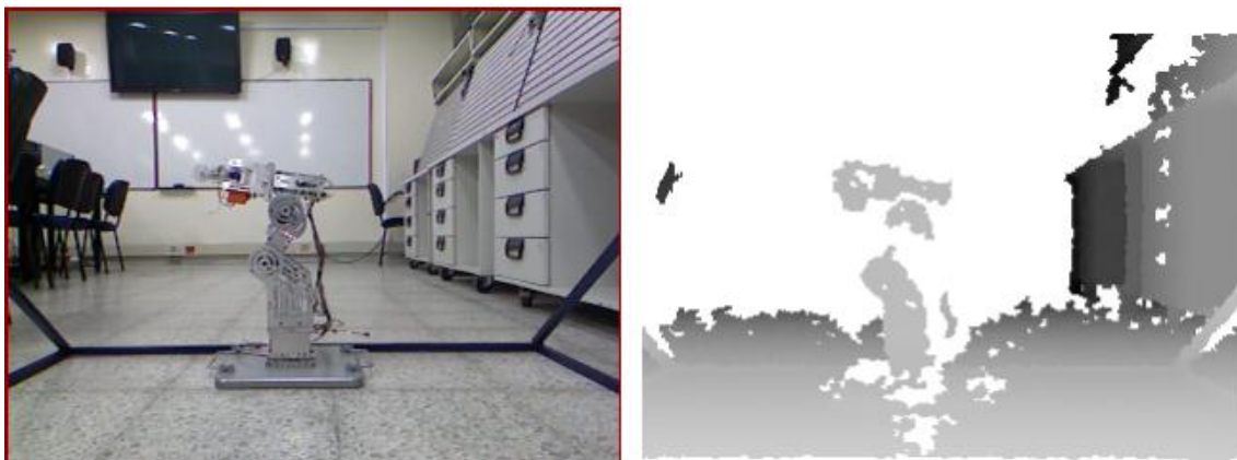
Figura: 16 Imagen RGB, Imagen profundidad capturada mediante método DepthAndPlayerIndex
