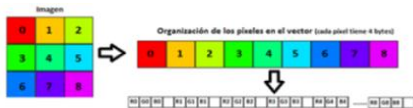
Figura: 11 Disposición de los pixeles RGB en el arreglo de bytes [4]
