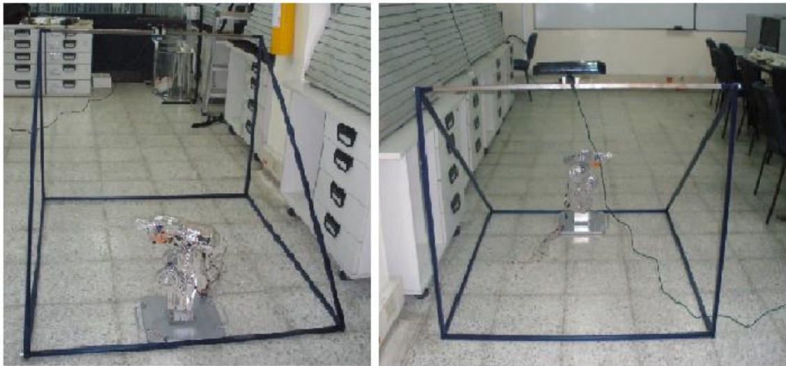
Figura: 33 Prueba mediciones diagonales con el Kinect
