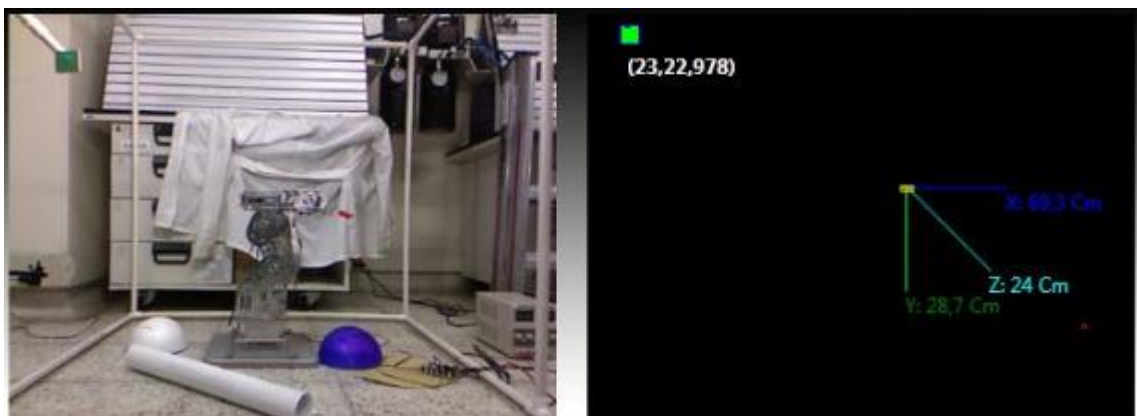
Figura: 23 Coordenadas X, Y, Z y tracking del objeto de interés
