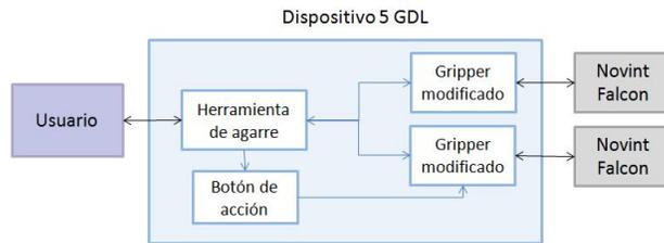
Figura 3.2: Diagrama de bloques dispositivo mecánico 5 GDL
