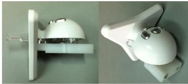
Figura 4.1: Modificación del *gripper* del *Novint Falcon*.
