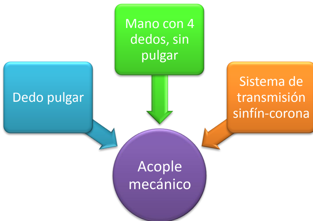
Figura 3.31 Elementos mecánicos constitutivos de la mano robótica
